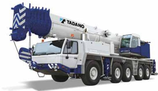
吊り上げ荷重100トン以上の超大型車
